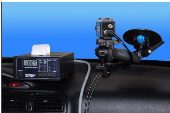
Fig. 10 - Sistema di ripresa del dispositivo fotografico FT1D montato in auto
