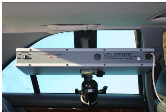
Fig. 5 - Rilevatore optoelettronico ROE montato in auto
