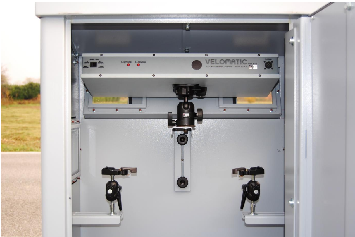
Fig. 9: Posizionamento del rilevatore optoelettronico ROE
